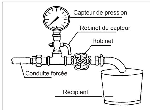
Pour effectuer cette mesure, un capteur de pression de précision est nécessaire, avec un calibre adapté à la pression (kg.cm<sup>2</sup>) à mesurer. Par exemple, si la hauteur "H" est estimée à environ 50m un capteur de 6kg.cm<sup>2</sup> ou 10kg.cm<sup>2</sup> max doit être utilisé.
