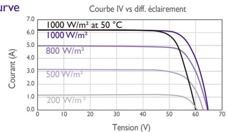
Caractéristiques courant/tension en fonction de l'éclairement et de la température du module.
